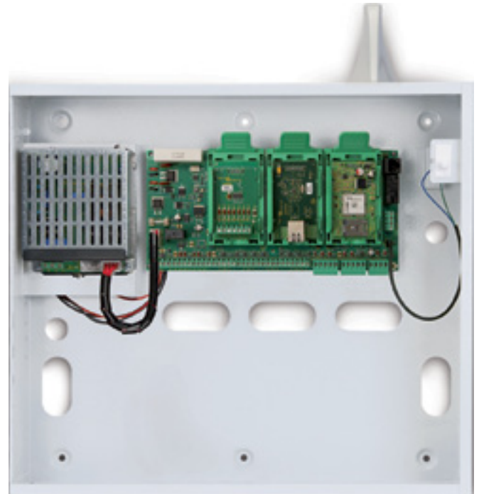
Unutrašnjost protuprovalne centrale
